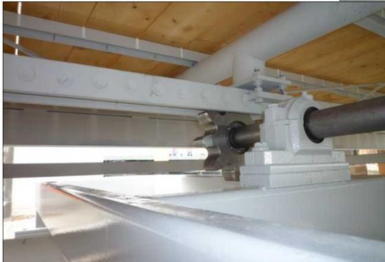
Für die Planungsleistungen bis Phase 6 nach HOAI für den Antrieb der Schiebebrücke war das Ingenieurbüro Lorenz zuständig. Es wurde ein Triebstockantrieb realisiert. Die Planungen der Elektro- und Steuerungstechnik wurden in unserem Auftrag extern erstellt.
