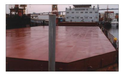
Die Hamburger Schiffswerft Pohl & Jozwiak führte den Auftrag zum Umbau eines Schiffs russischer Eigner aus. Die 'Volshski-10', ein Wolga-Flußschiff, sollte durch Verkürzung des Rumpfs, Verstärkung der Sülle und Ersatz der Lukenabdeckungen 'seegehend' gemacht werden. Die Planung der neuen Lukenabdeckungen wurde im Ingenieurbüro Lorenz ausgeführt.
